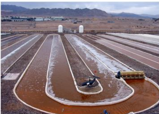
Impianto pilota costiero di D. , situato all'interno del sito di produzione della NBT (Ltd) a Eilat, Israele. Piste allineate 150 m di lunghezza x 4 di 5 m di larghezza, acqua salata profonda 20 cm. Ceppo locale, Dunaliella Bardawil . Foto presa da: Harvey, Patricia J., and Ami Ben-Amotz.
